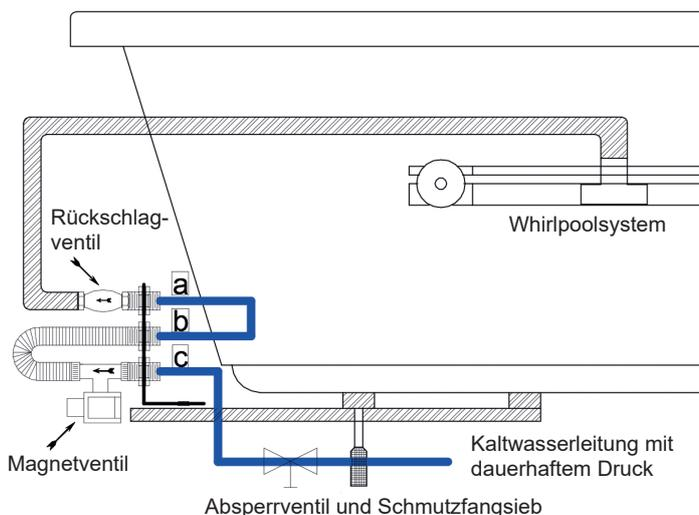
Wenn kein Rohrunterbrecher gesetzt wird, verbinden Sie die Anschlüsse a und b durch einen Verbindungsschlauch 1/2" AG (nicht im Lieferumfang enthalten).
