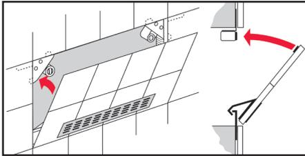
Beim Alpro 2000 Whirlpool-Set wird in die Klappe ein Lüftungsgitter in der Standardgröße eingesetzt. Mehrere Fliesen werden mit Alu-Trägerblechen verbunden. Bei Rundungen und Ecken lassen sich die Alu-Bleche problemlos in die gewünschte Form bringen. Das Lüftungsgitter ist dann an geeigneter Stelle senkrecht einzukleben.
